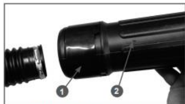
Рис. 3 Труба напорная «А» 1. Втулка 2. Маркировка трубы «А»
